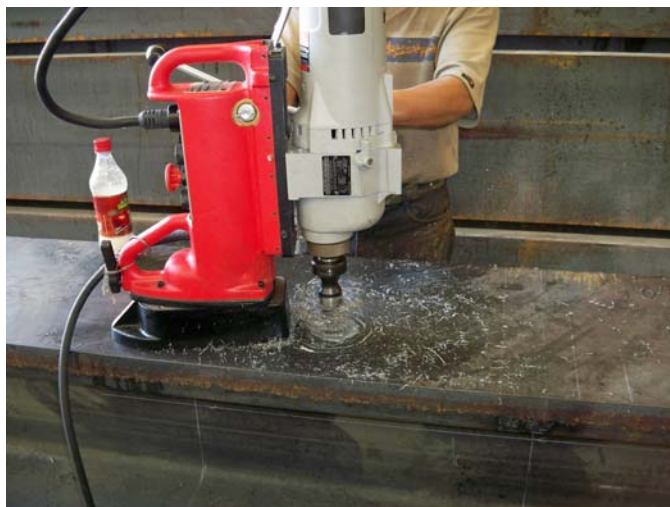
Fig. IV.4 Barrenación de placa con taladro automatizado.
