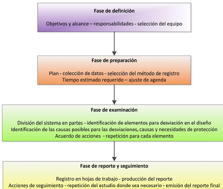
**Figura I-17. Secuencia del proceso del análisis HAZOP**
