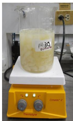
Figura 4.13. Albedo en proceso de ebullición
