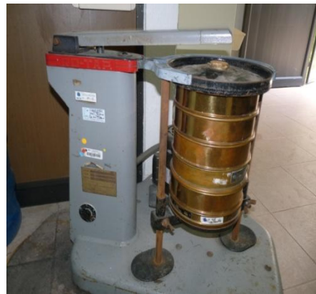
Figura 4.10. Tamizador para llevar a cabo la granulometría
