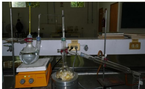
Figura 4.24. Montaje de arrastre de vapor
