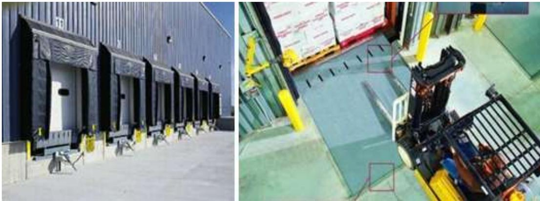
**Figura 6.5.2 Rampa niveladora Andén Rite-Hite**
