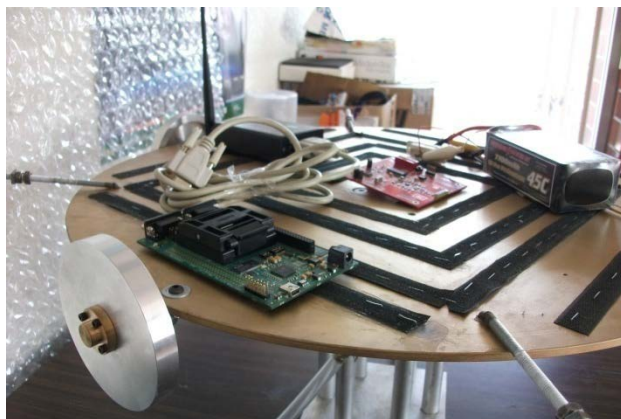
Figura 7. 1 Mesa suspendida en aire instrumentada con DSP en proceso de integración.
