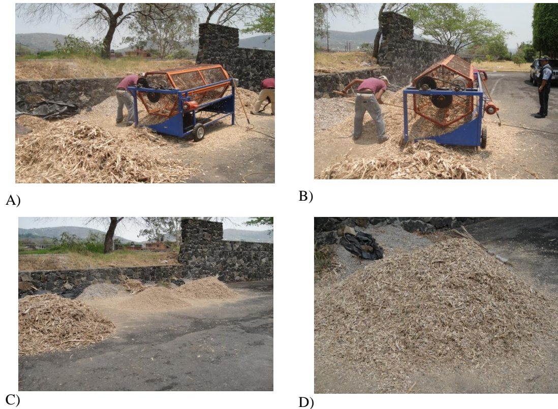
Figura 3.24. Tamizado del material orgánico. En la figura A y B ilustran el proceso de tamizado del ficus. C) muestra las tres granulometrías obtenidas después del tamizado. D) es la fotografía del tamaño de partícula a utilizar.
