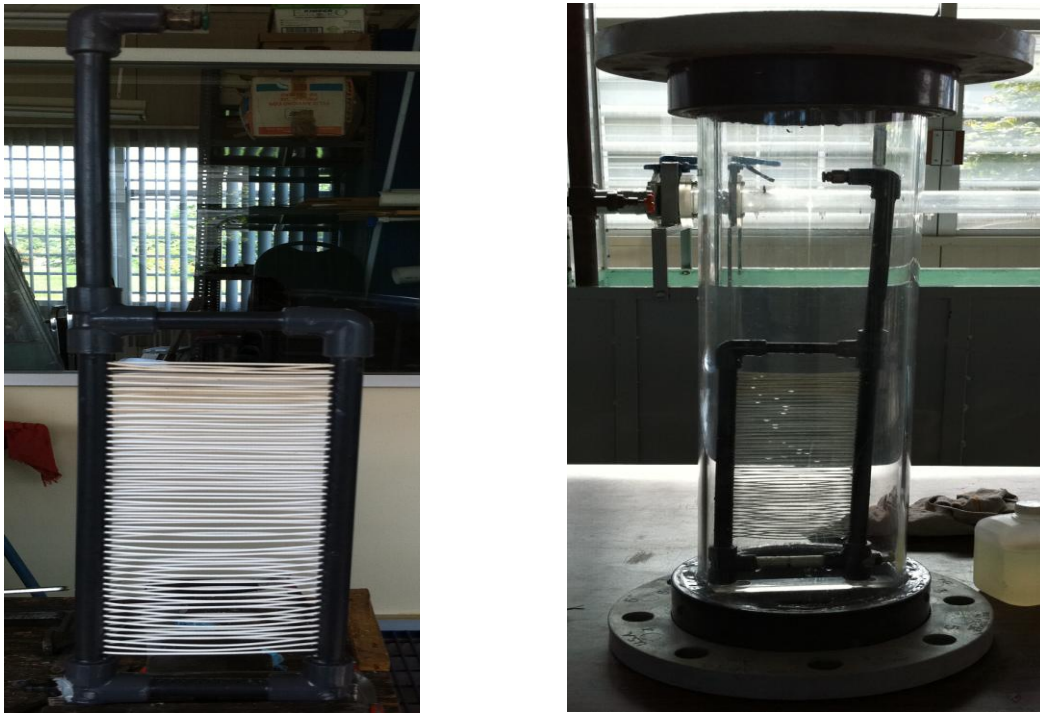
Figura 2.17. Instalación de las membranas en el módulo y montaje del módulo de membranas en el reactor de membranas.
