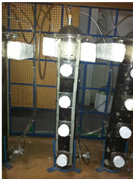
Figura 2.15. Biofiltro empacado con material de empaque orgánico.
