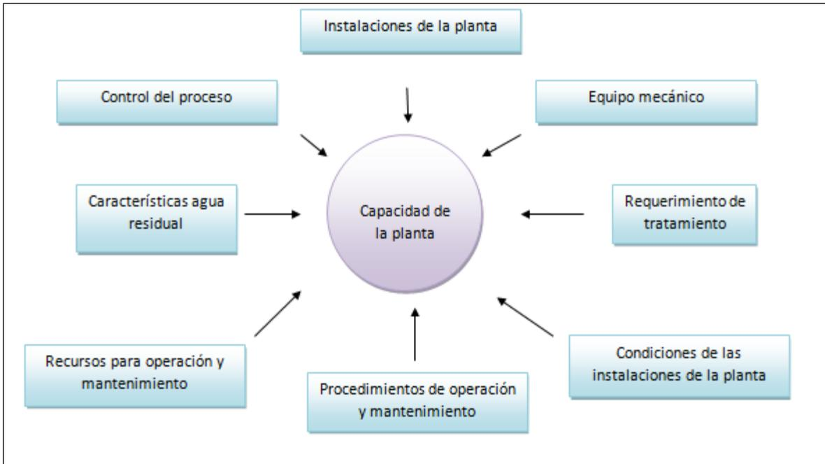
Figura 3.1. Factores que afectan la capacidad de la planta (Daigger, 1992).
