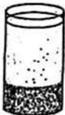
Buena sedimentación y sobrenadante limpio en la prueba, lodos flotando en el sedimentador secundario.
