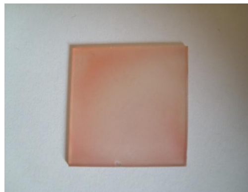
Figura 4.18 Películas de ZnO:Al con RA151 después de ser sometidas a un proceso de desorción
