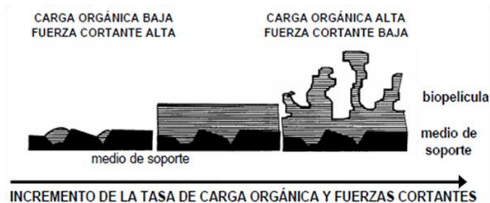
Figura 2.6. Representación esquemática de la influencia de la carga orgánica y las fuerzas cortantes sobre la estructura de las biopelículas (van Loosdrecht et al. , 1995).
