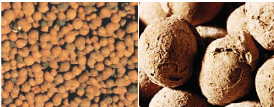
Figura 2.3. Biolite - material de empaque para el proceso BIOFOR®.
