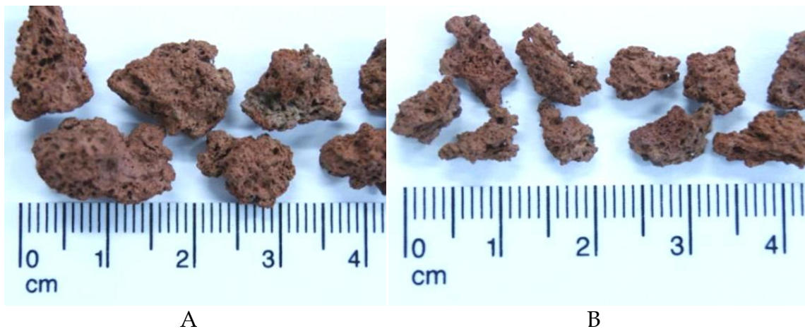
Figura 4.1. Partículas del lecho filtrante. A y B muestran el tezontle con tamaño promedio de partícula de 9.5 y 4.75 mm respectivamente.
