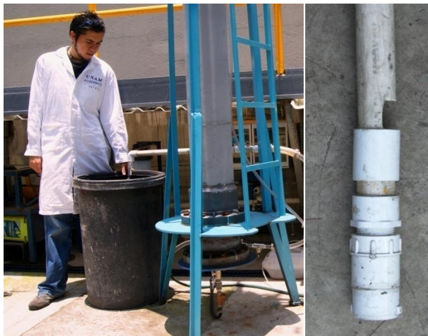
Figura 3.10. Operación de retrolavado y dispositivo empleado para el muestreo de piedras durante el retrolavado.
