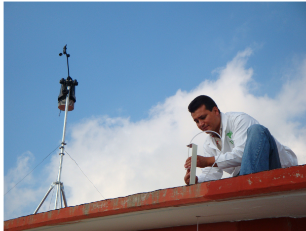
Figura 4.14. Toma de muestra y estación meteorológica en la azotea del sitio de monitoreo del CECATI 55.
