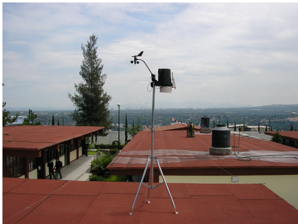
Figura 4.17. Estación meteorológica instalada en la azotea de la Dirección de la Escuela Lázaro Cárdenas.
