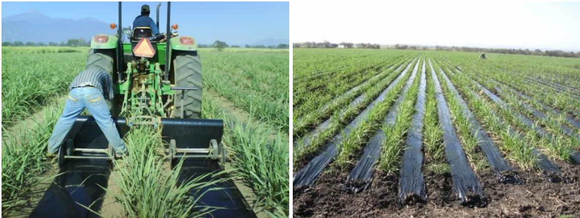
Figura 4.52 Sistema de acolchado cañero (SAGARPA 2009b).
