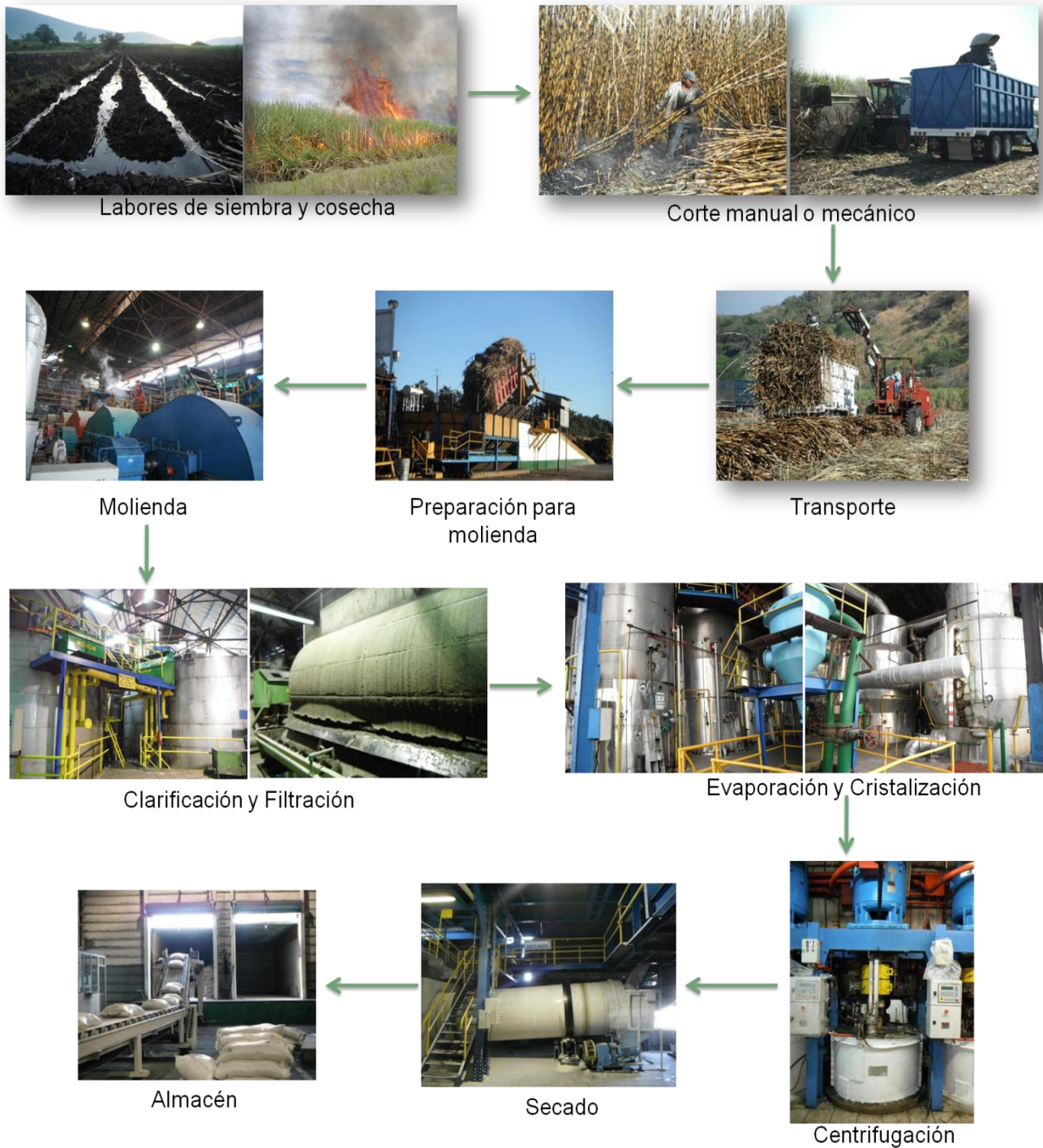
Figura 2.13 Diagrama de proceso general de producción de azúcar de caña en México.
