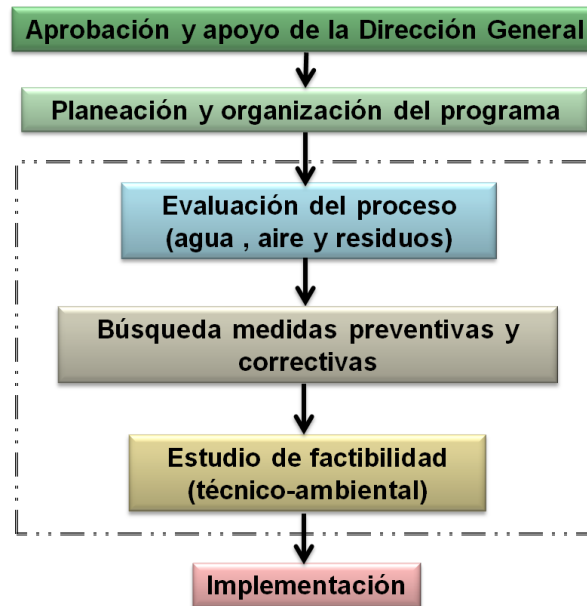
Figura 3.1 Esquema de las etapas en la elaboración del programa de prevención, minimización y control de la contaminación.
