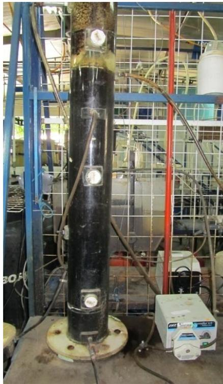
Figura 3. 4 Fotografía del reactor anaerobio tipo UASB.
