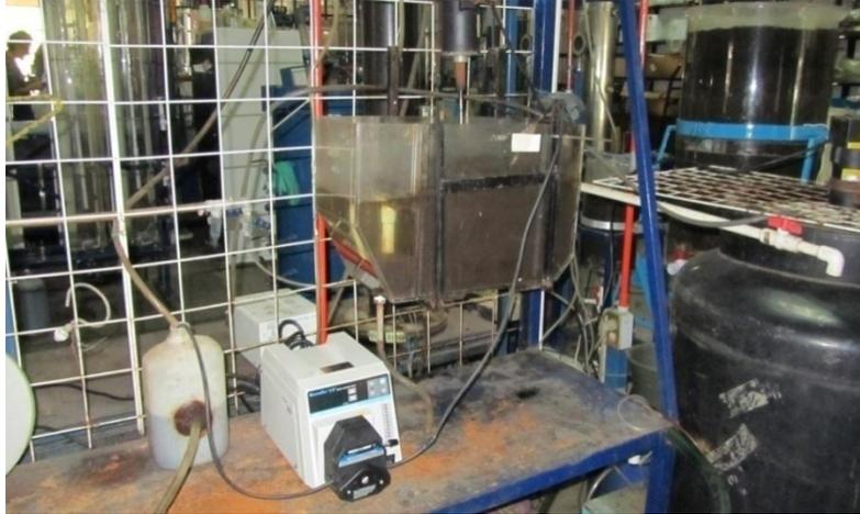
Figura 3. 5 Fotografía del reactor de Lodos Activados con Aireación Intermitente.
