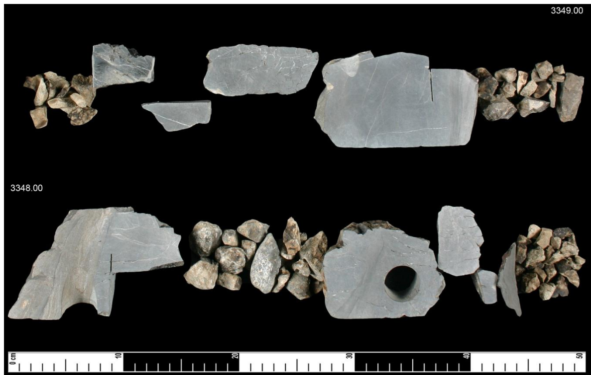
Figura 5.- Núcleo 3 del pozo P-DL1 del Cretácico Medio se observa una caliza tipo Mudstone laminada con poca impregnación de hidrocarburos
