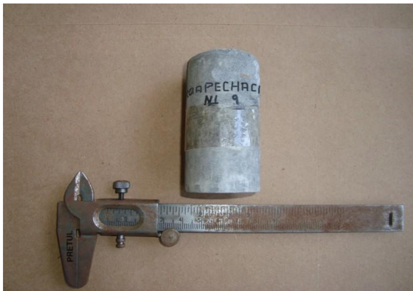
Figura 2.10. Especimen de la formación Chicontepec del campo Coapechaca usado en pruebas geomecánicas de laboratorio [43].
