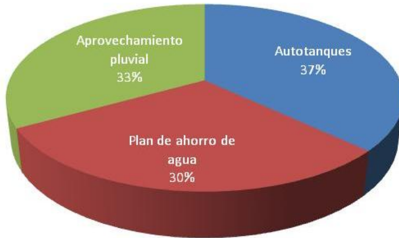
Figura 5.27. Abastecimiento de agua a nivel doméstico con sistema de captación pluvial con 100 m 2 , plan de ahorro y autotanques.
