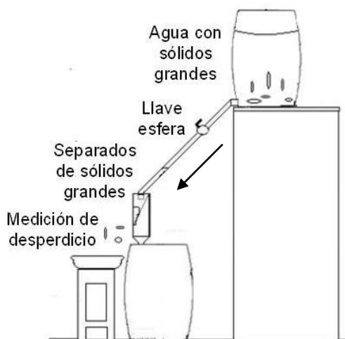
Figura 4.14. Arreglo para evaluación de separador de sólidos grandes.
