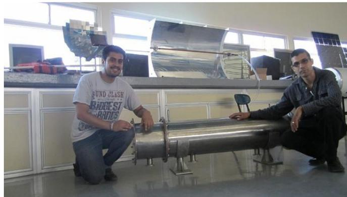
Figura 4.5 Sistema de evaporación MED-LE
