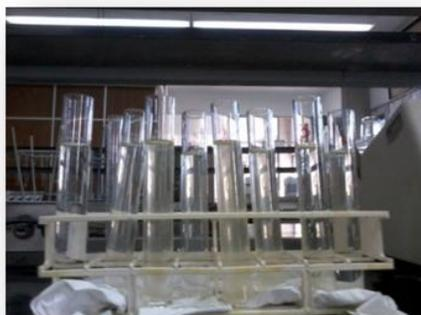
Figura 5.2. Método de colorimetría para nitrógeno amoniacal
