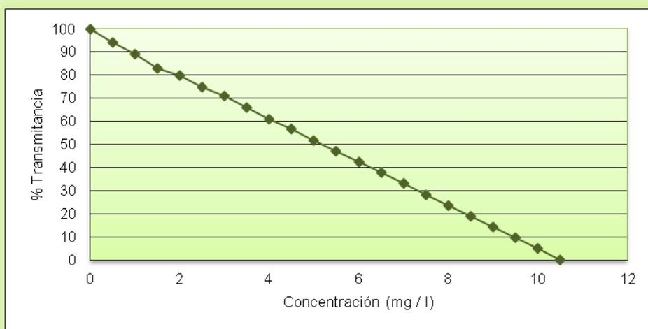
Figura 5.1. Curva de calibración de nitrógeno amoniacal
