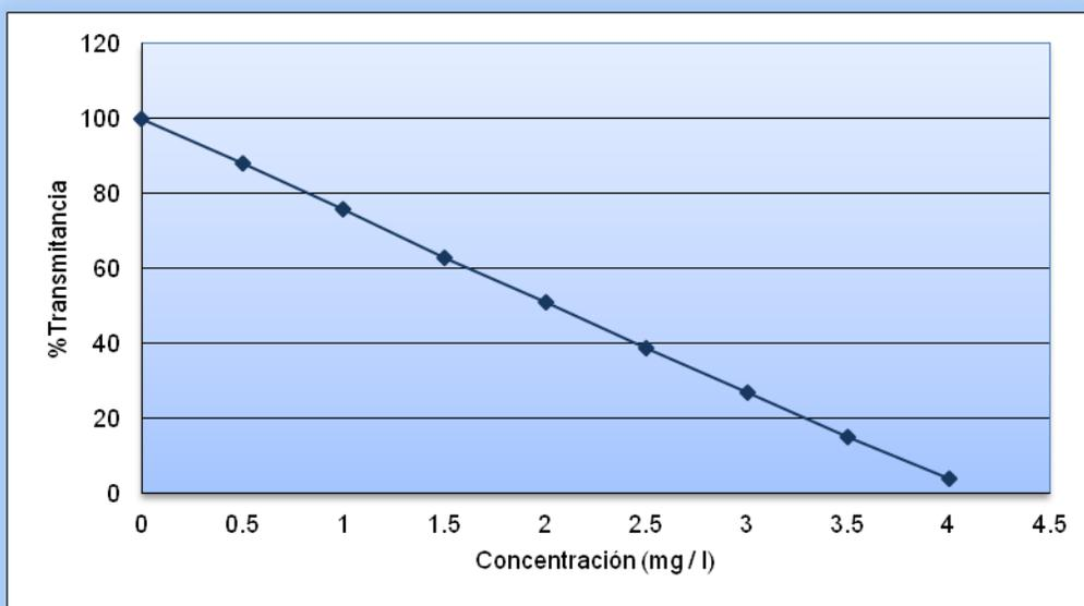
Figura 5.7. Curva de Calibración de Fósforo
