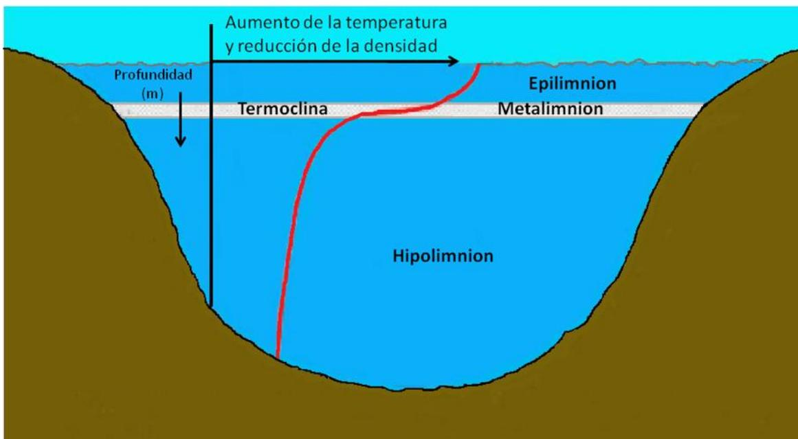
Figura 2.5. Estratificación térmica (modificado de Dias y Barroso, 1995)
