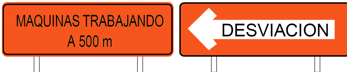
Figura 5.2 Señales informativas para protección en obra (SPI).
