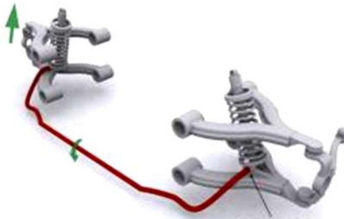
Figura 1.5. Funcionamiento barra estabilizadora (Longhurst, 2012)
