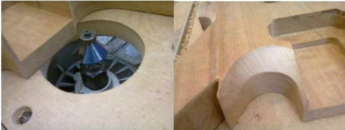
Fig. 7.6 Broca biselada y su respectivo acabado después de ser usada
