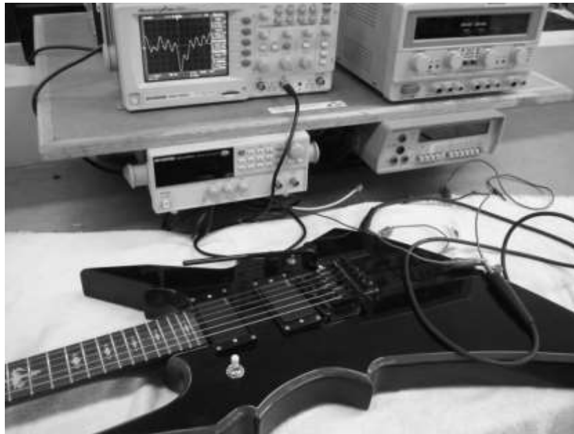
Fig. 8.1 Experimento para medir la salida de voltaje de la guitarra
