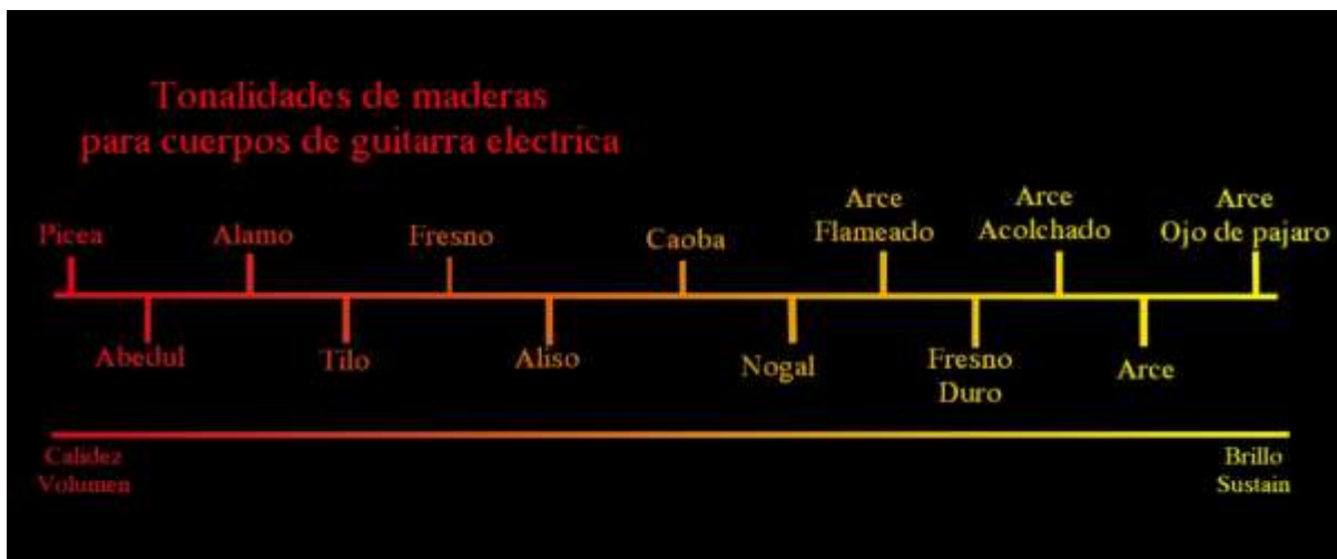
Fig.6.2 Esquema comparativo de los tonos de diferentes maderas para cuerpo de guitarra que van desde lo grave en rojo, hasta lo agudo en amarillo 18
