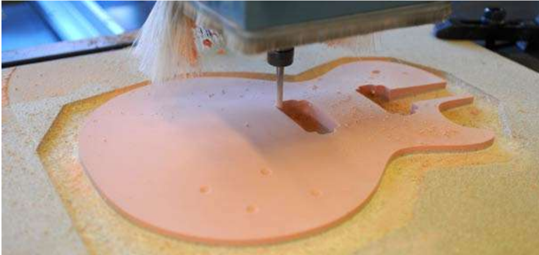
Fig. 7.1 Sistemas CNC se encargan de cortar perfilar y desbastar la madera para guitarra 41
