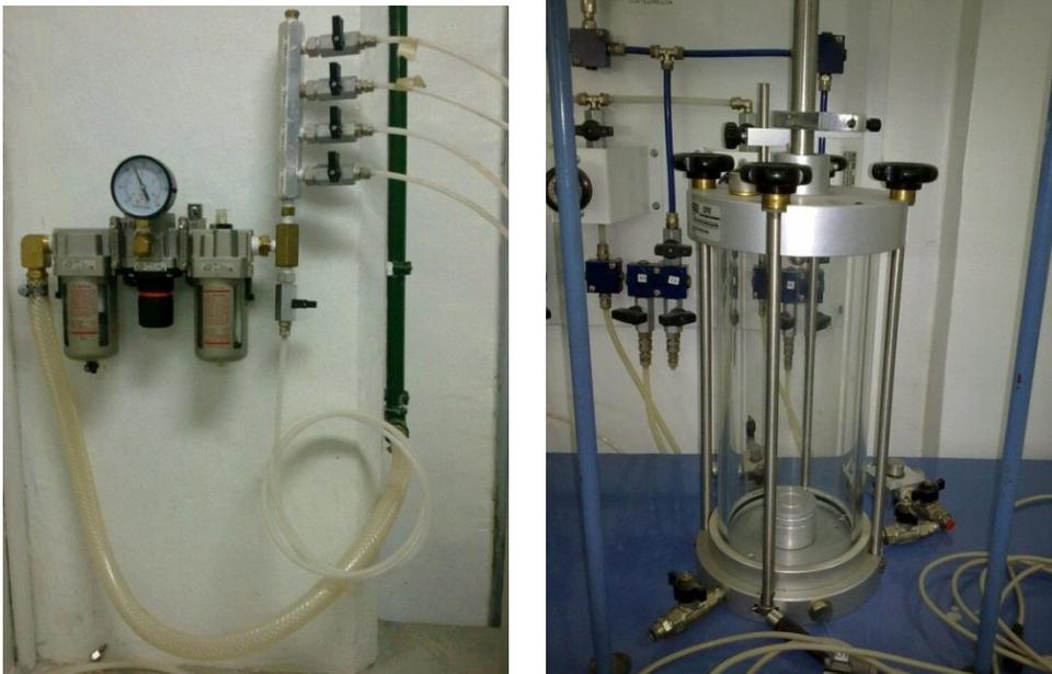
Figura 9 Regulador de presión integrado y cámara triaxial para realizar ensayos mecánicos y secar matraces.
