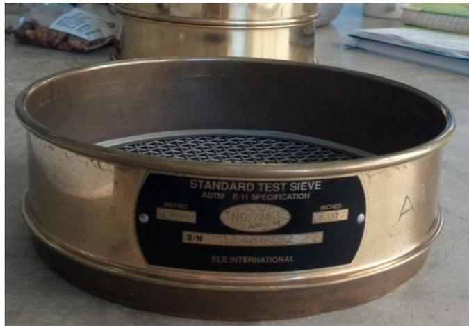
Figura 1 Tamiz de 4.75 mm (Malla N°4) para separar tamaños de grano de una muestra.
