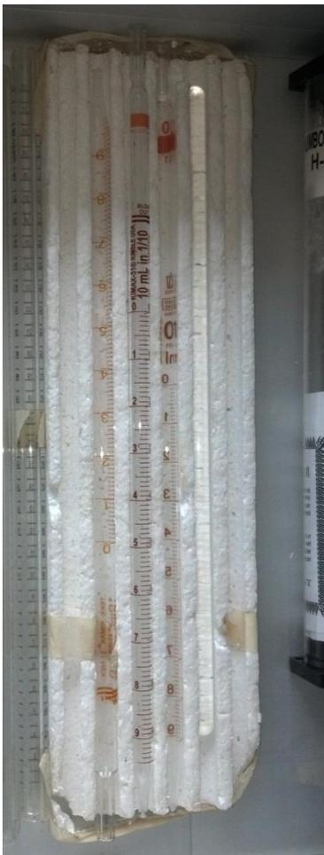
**Figura 7** Pipetas y varilla de vidrio para realizar el aforado y limpieza del cuello del matraz.
