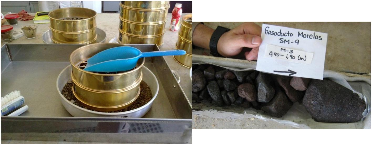
Figura 18 Separación de grava del espécimen para realizar el ensayo y Muestra de grava.
