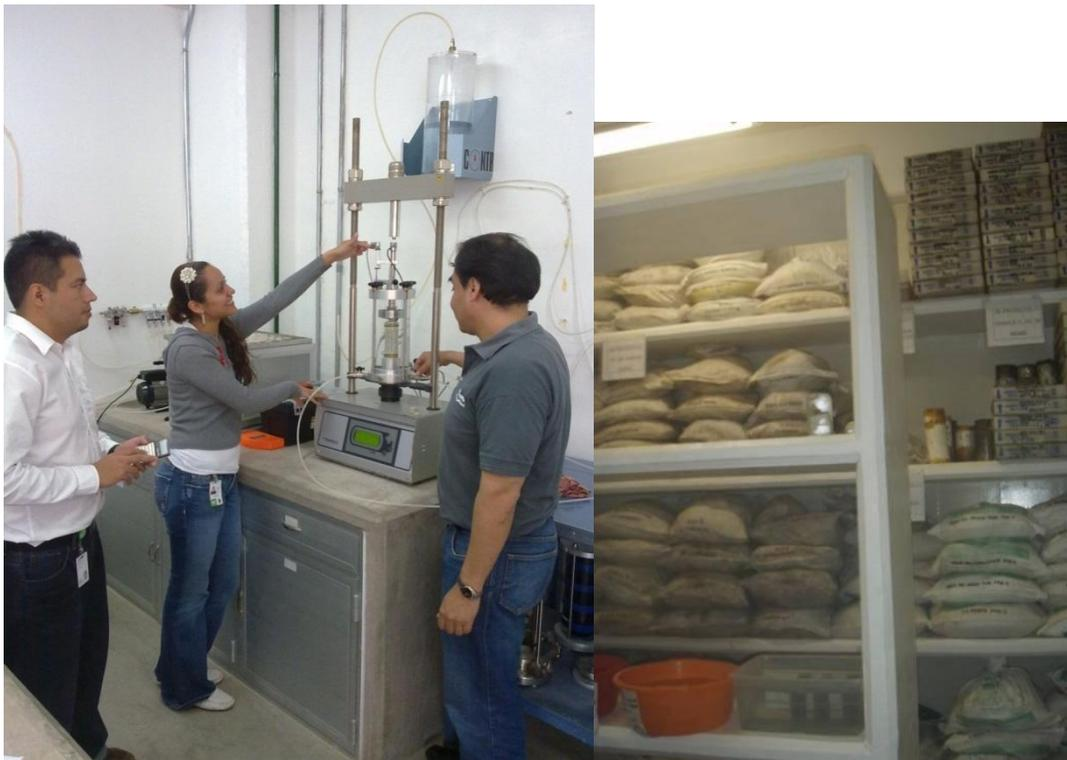
Figura 13 Capacitación para realizar ensayos de triaxial del área mecánica y Cuarto Húmedo para almacenar muestras inalteradas y mantener su humedad.
