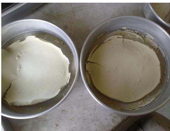
Figura 20 Muestra de arcilla en tubo shelby para ensayo por vía húmeda y espécimen de arcilla seco.
