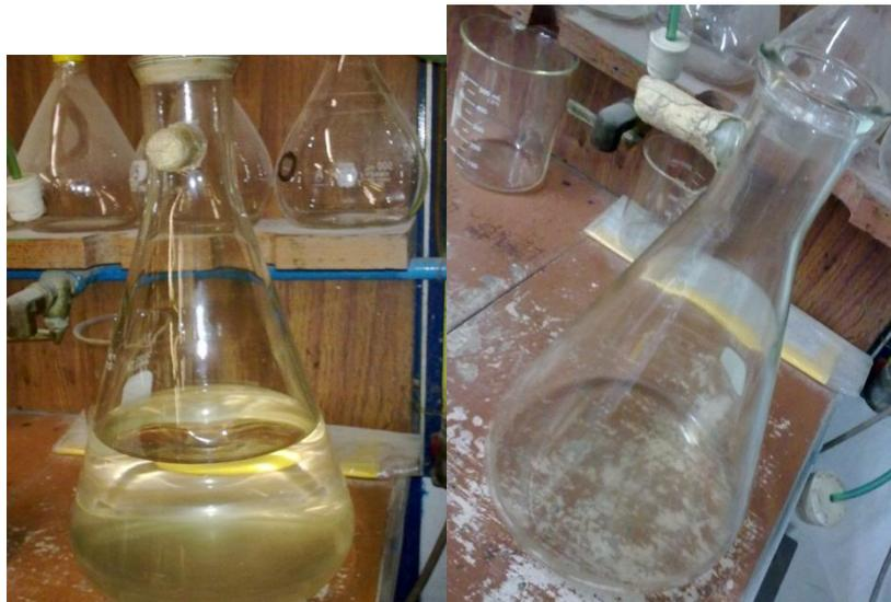
Figura 26 Matraz kitasato con agua desaireada para añadir al matraz aforado.
