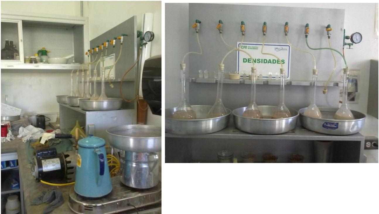
Figura 25 Combinación de vacío y baño maria para desairear el espécimen con mayor calidad.
