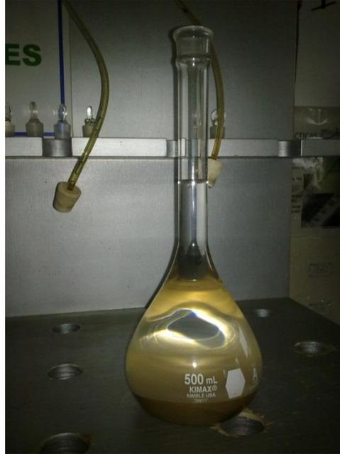
Figura 24 Especímenes desaireados, aforados y listo para pesarlos.
