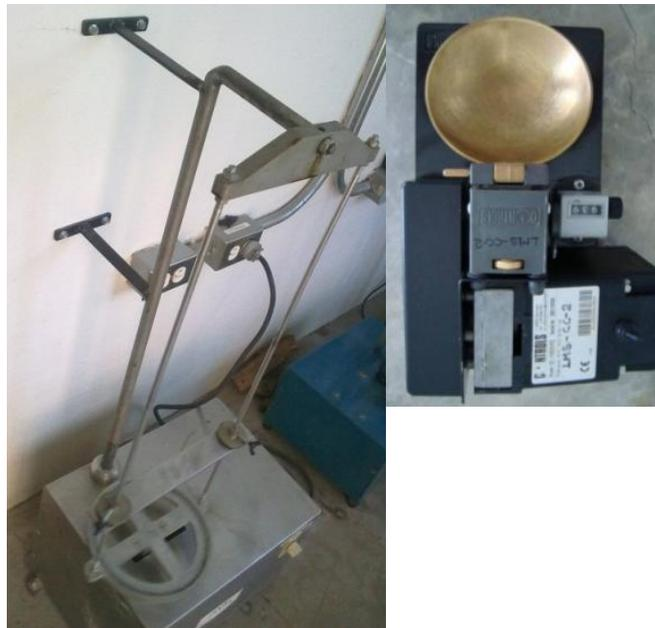
**Figura 8** Tamizadora, Mortero y Copa Casagrande para realizar el tamizado mecánico y límite de consistencia para obtener la granulometría y clasificación SUCS.
