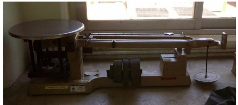
Figura 19 Obtención de masa aparente  $W_3$  y Balanza mecánica para pesar muestras.
