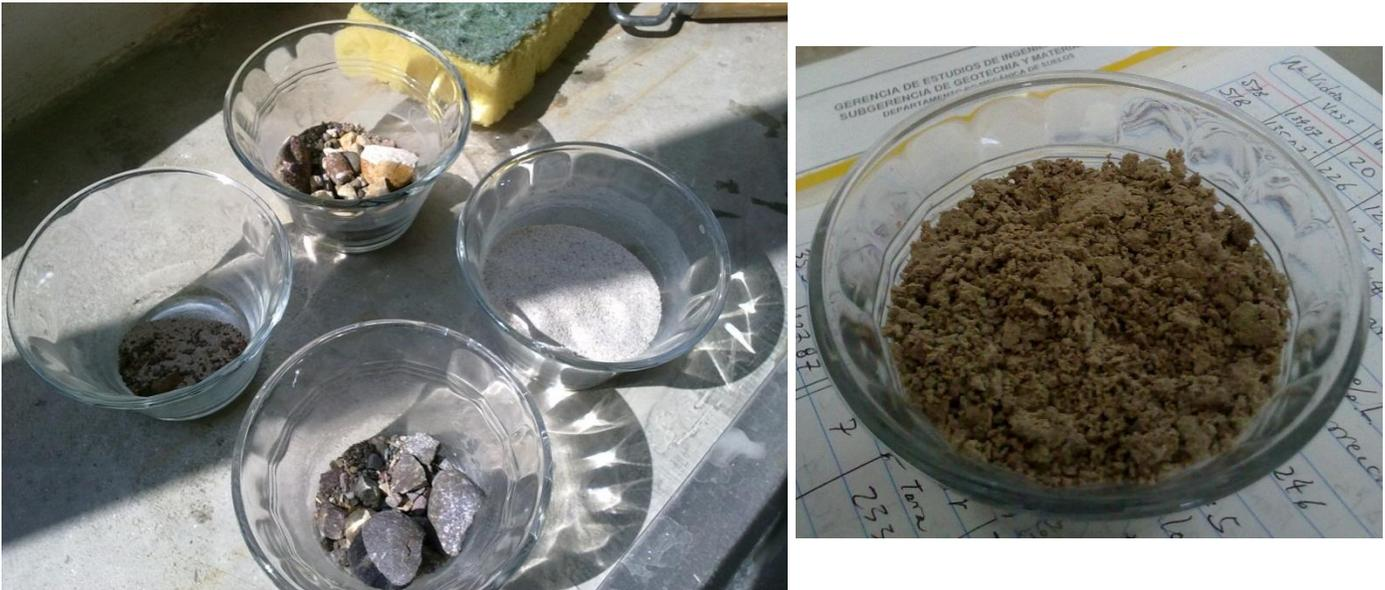
Figura 4 Los especímenes secos de la muestra conforman las partículas sólidas del suelo con las cuales realizamos el ensayo por vía seca.
