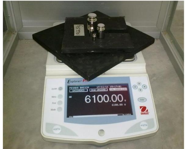
Figura 6 Balanza analítica calibrada para pesar los especímenes a ensayar.
