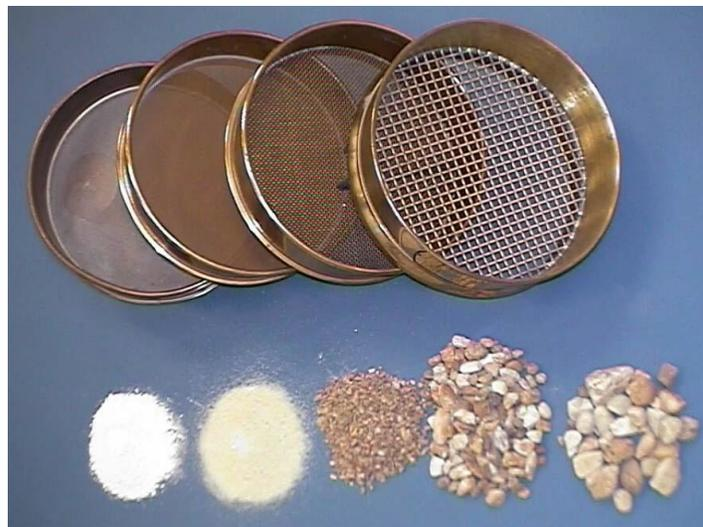
Figura 3 Espécimen de muestra de suelo, separado por sus tamaños de grano, logrado después del tamizado.
