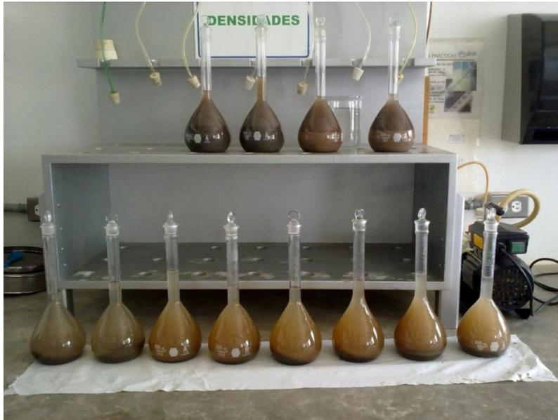
Figura 21 Seis especímenes de arena y arcilla desaireados y listos para aforarlos.
