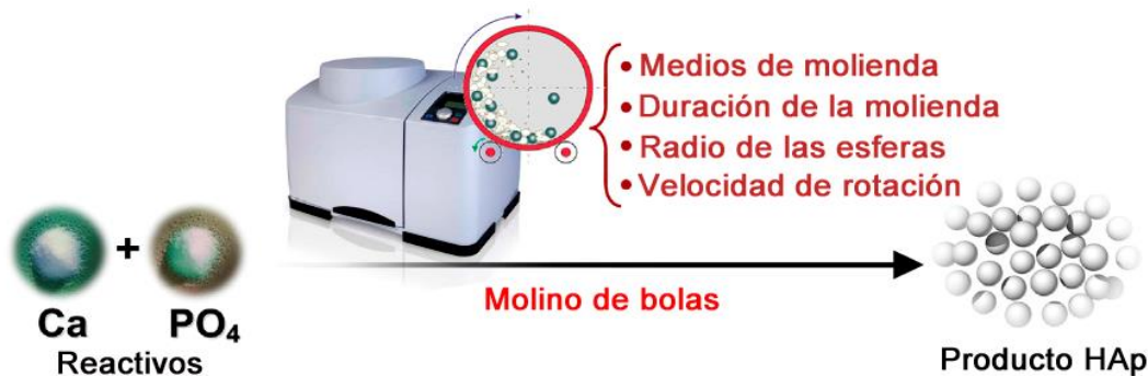
Figura 3.7 Esquema general del proceso mecano químico. (Wang et al., 2005).
