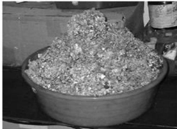
Figura 2.12 Un lote de TiN obtenidos por el método de SHS (Lech Pawlowski, 2008).
