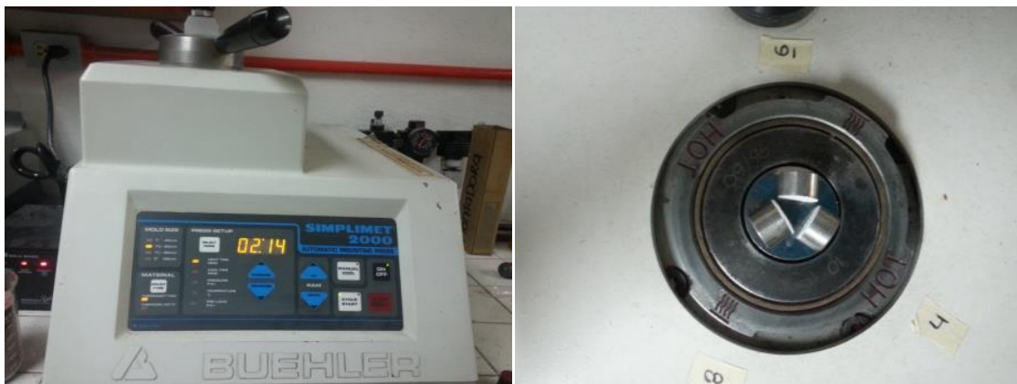
Figura 7.22 a) Montadora de baquelita Buehler b) Acomodo de probetas para realizar el montaje
