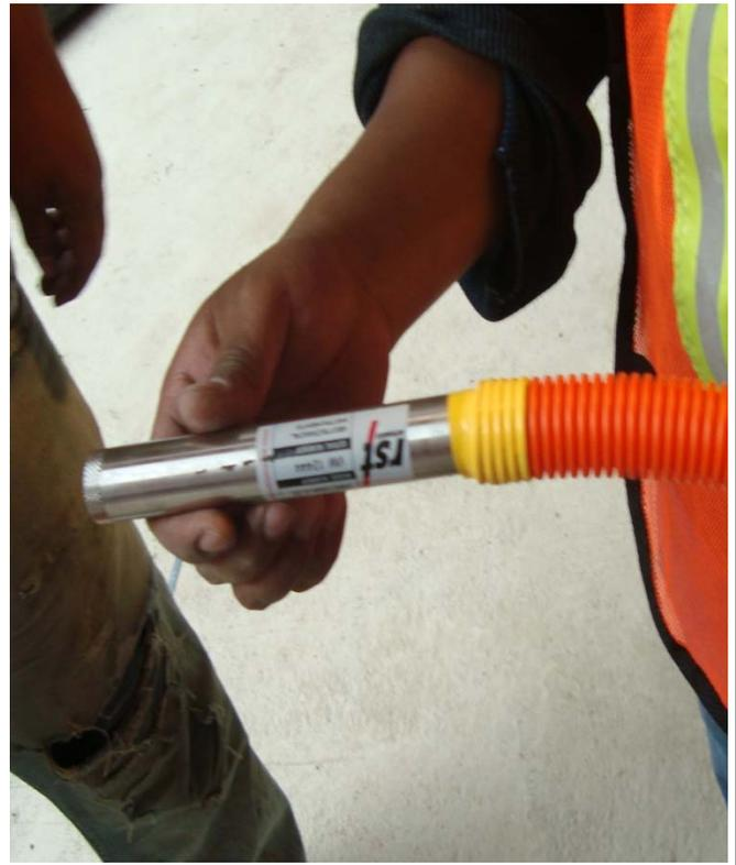
Foto 2.- Protección de cable de señal con poliducto flexible
