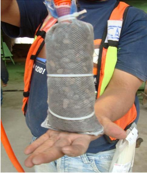
Foto 3.- Colocación de piezómetro dentro de bolsa de geotextil con granzón
