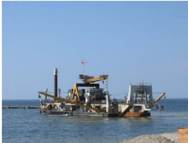
Figura 7. Fotografía de la CDS (Draga de succión y corte)
