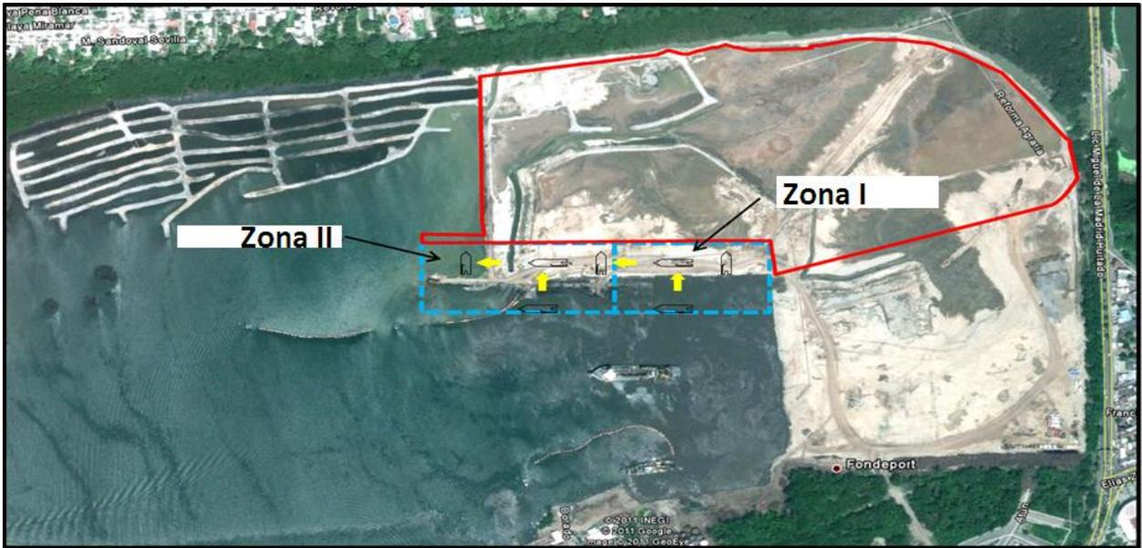
Figura 28. La imagen de arriba muestra el área a dragar, dividido en dos partes "Zona I" y "Zona II".
