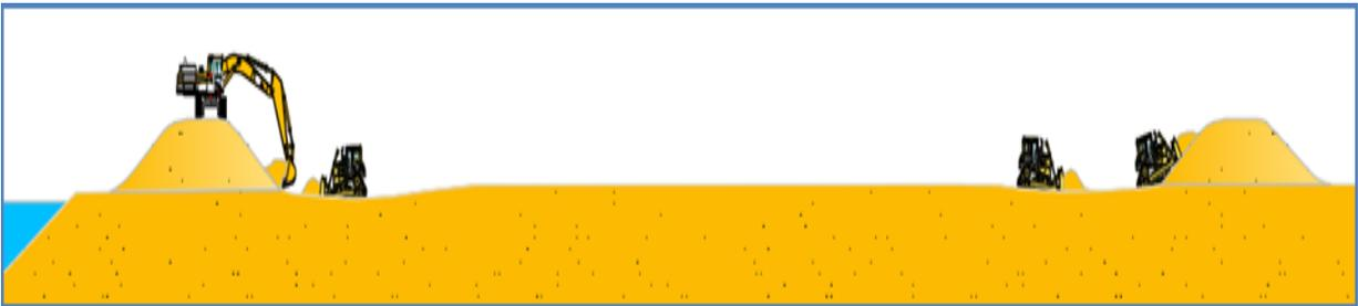
Figura 19. Esquema típico del arreglo de diques y bordos usando bulldozers y una excavadora
