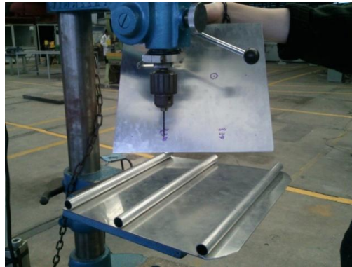
Figura 66. Proceso de elaboración y ensamblaje del asiento.
