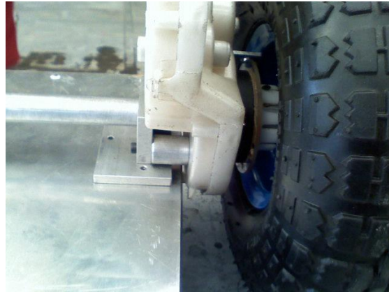
Figura 61. Acoplamiento de caja reductora y eje.
