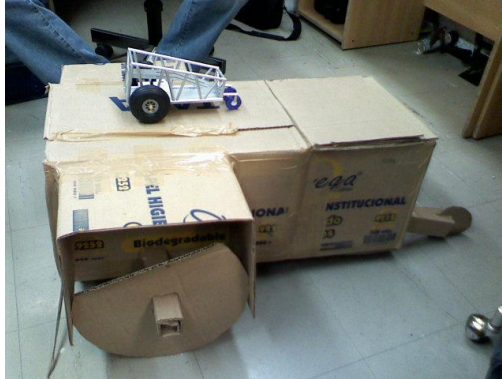
Figura 18. a) Propuesta de estructura con llantas de escala 1:4. b) Comparación de dimensiones de la silla entre modelo a escala 1:4 y 1:1.
