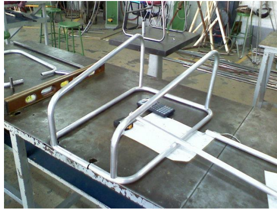
Figura 50. Finalización de doblado tubular.
