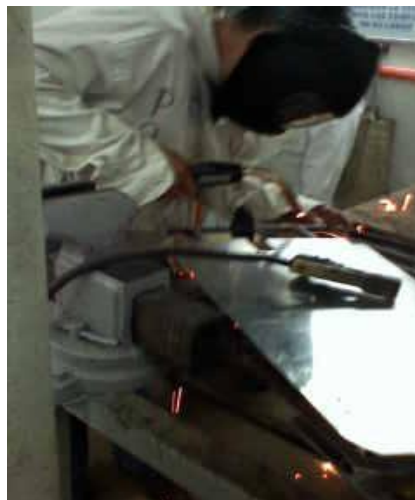
Figura 68. Soldado de bujes al eje del respaldo.
