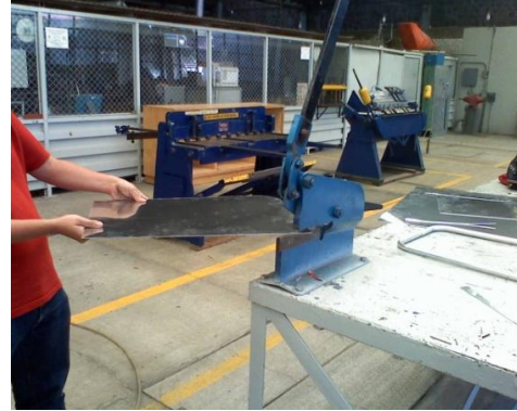
Figura 52. Corte de lámina con cizalla manual
