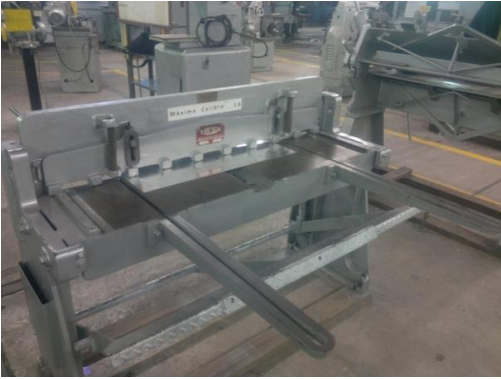
Figura 51. Corte de lámina en cizalla de pedal
