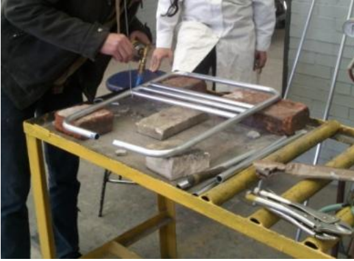
Figura 53. Soldado de la estructura.
