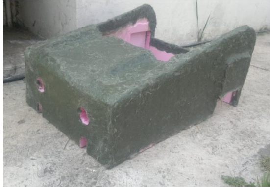
Figura 76. Aplicación de la fibra de vidrio al molde.
