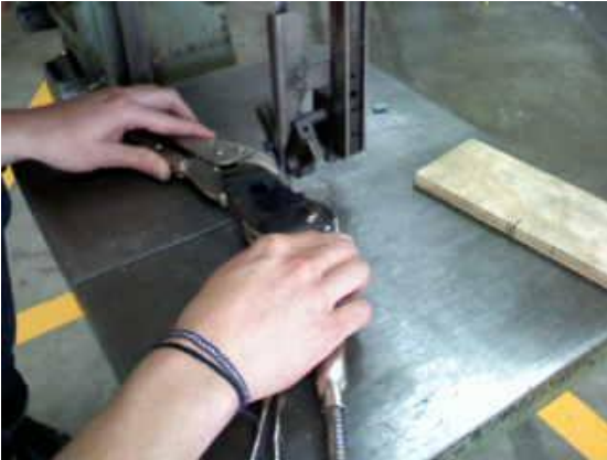
Figura 72. Corte de nylamid.
