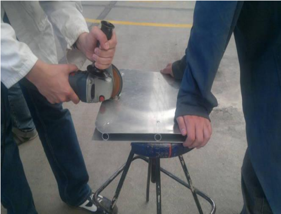
Figura 64. Corte para colocación de engrane.
