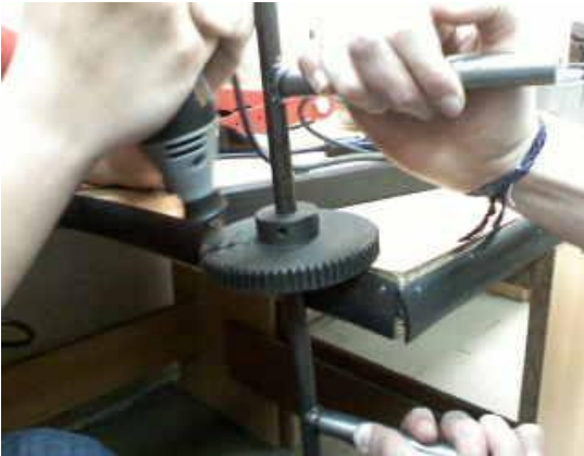
Figura 69. Corte de engrane.
