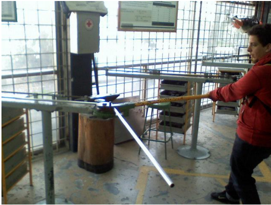
Figura 49. Doblado de tubo
