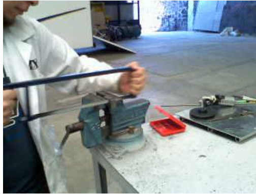
Figura 71. Corte de hierro colado para fabricación de rodete.
