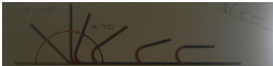
Figura 47. Muestra gráfica de doblado de tubo.
