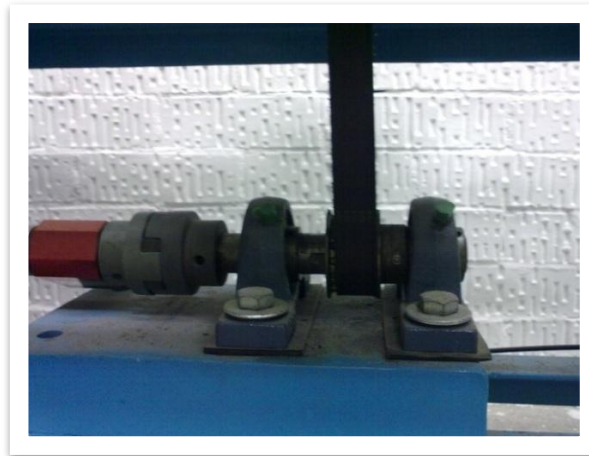
Figura 3.2 Imagen del mecanismo de transmisión, polea-banda síncrona.
