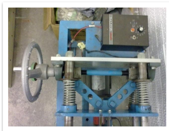
Figura 3.3 Imagen del mecanismo carga, volante-tornillo de potencia.
