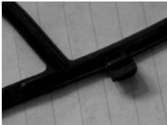
Figura 2. Detalle de un empaque del tipo "clip-on" 2 .
