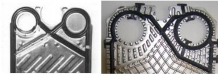
Figura 7. Diferentes configuraciones de placas para los diferentes arreglos de flujo 7 .
