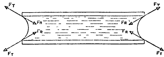
Figura 112 Esquema que ilustra la generación de presiones capilares en un tubo capilar
