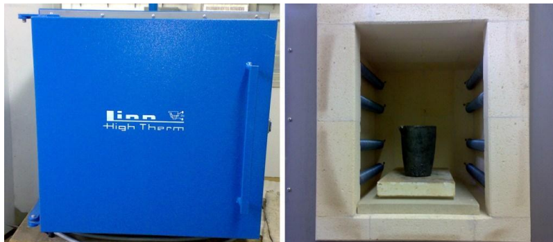
Figura 2.1 Horno de resistencias eléctricas del Instituto de Investigaciones en Materiales, UNAM.
