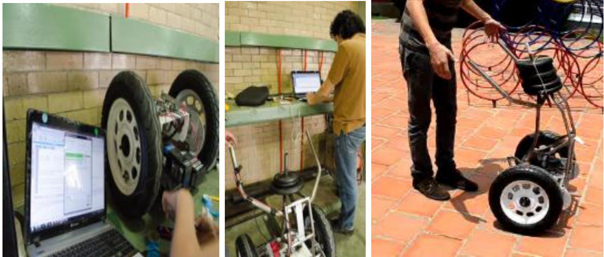
Figura 7.2. a) Cargando el software de monitoreo, b) prototipo con las pesas encima y ajustando el programa del controlador, c) el prototipo durante una prueba con peso muerto.
