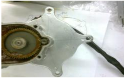
FIGURA 3.4. Fotografía de la brida de montaje de los motores, donde se aprecia la ubicación de cada barreno.
