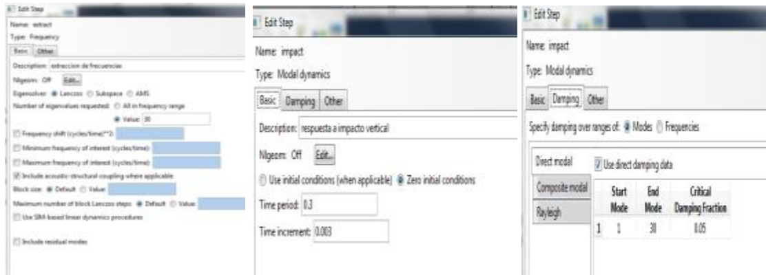
FIGURA 4.16. Definición de las características de los steps creados para extraer las frecuencias naturales y para asignar cargas dinámicas al modelo.
