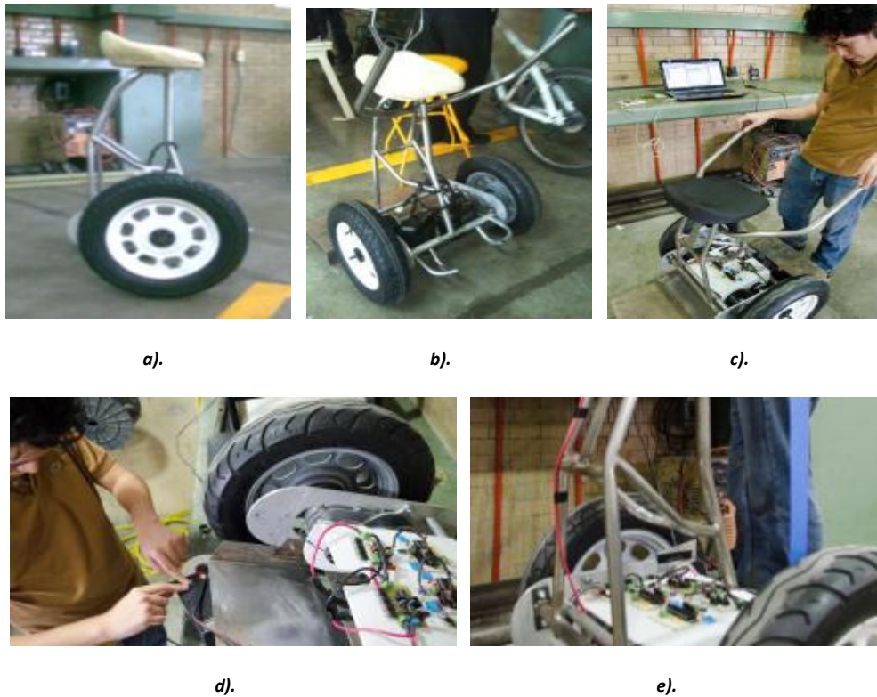
FIGURA 6.7. a) y b) prototipo ensamblado con las estructuras, motores, baterías y ruedas; c), d) y e) montaje de los circuitos de control y potencia.
