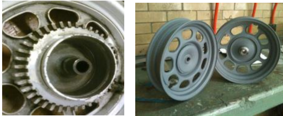
FIGURA 6.5. Izquierda, fotografía de la parte trasera de los rines donde se ven los elementos a retirar; derecha rines ya modificados y con los bujes insertados.
