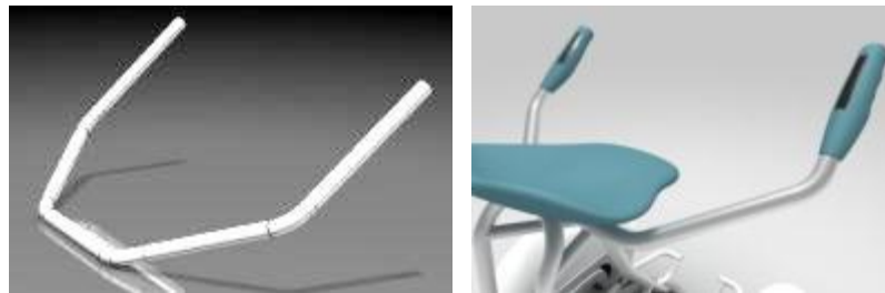
FIGURA 3.8. Izquierda modelo del soporte tubular del mando de operación. Derecha imagen donde se muestran las empuñaduras con los paneles táctiles que se desean implementar.
