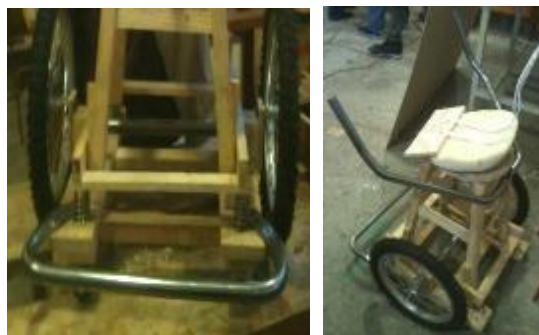
FIGURA 2.7. Estribos y uno de los mandos hechos de tubo doblado.
