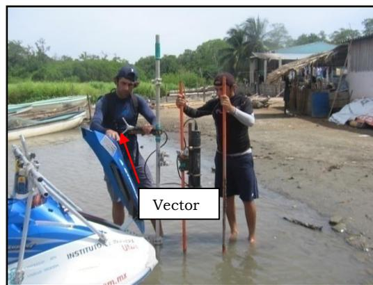
Figura 1.10 Velocímetro acústico
