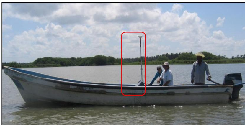
Figura 1.3 Sistema de medición del fondo marino
