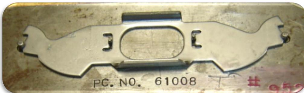
Figura 4.9 Pieza obtenida del primer paso
