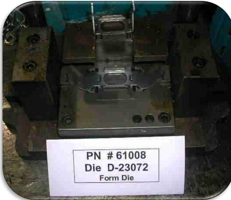
Figura 4.12 Troquel de Formado de operación manual
