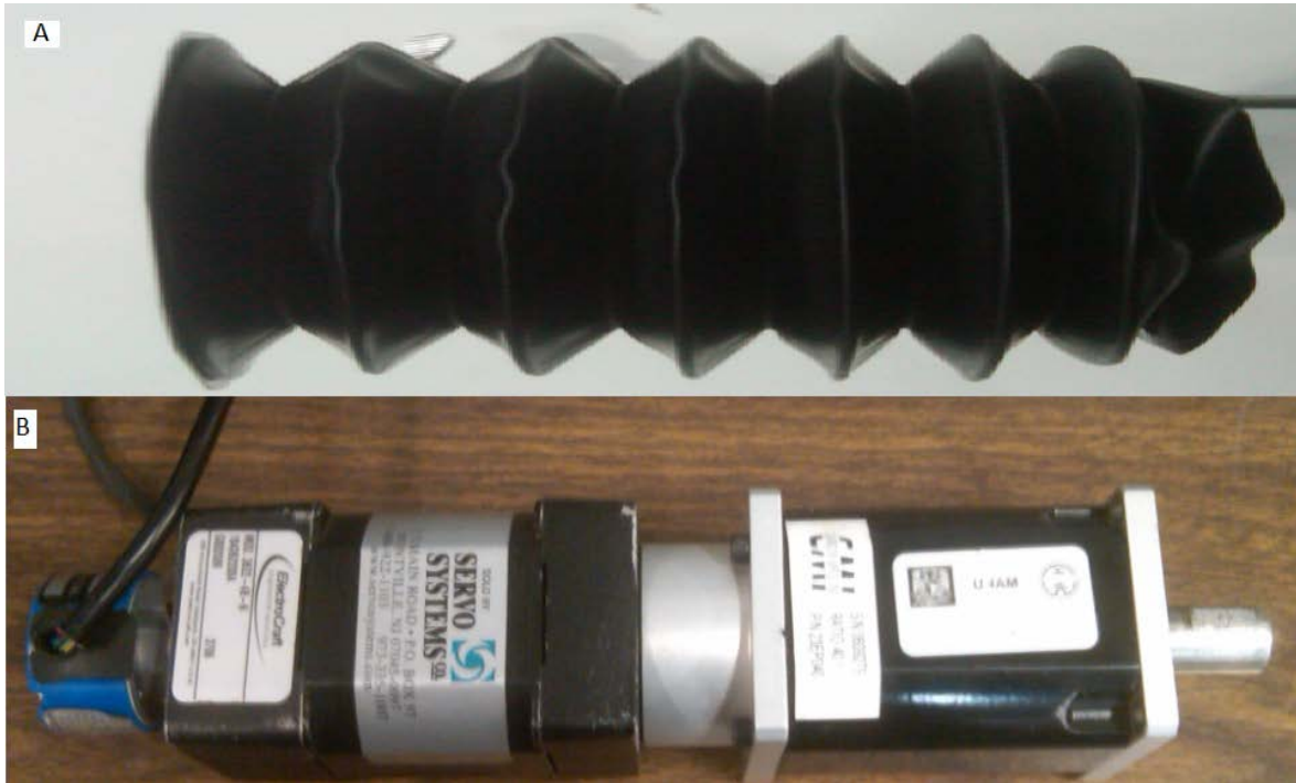
Fig. 3.5 (A) Fuelle adquirido en GrupoSim. (B) Servomotor, caja reductora y encoder adquiridos en servosystems.
