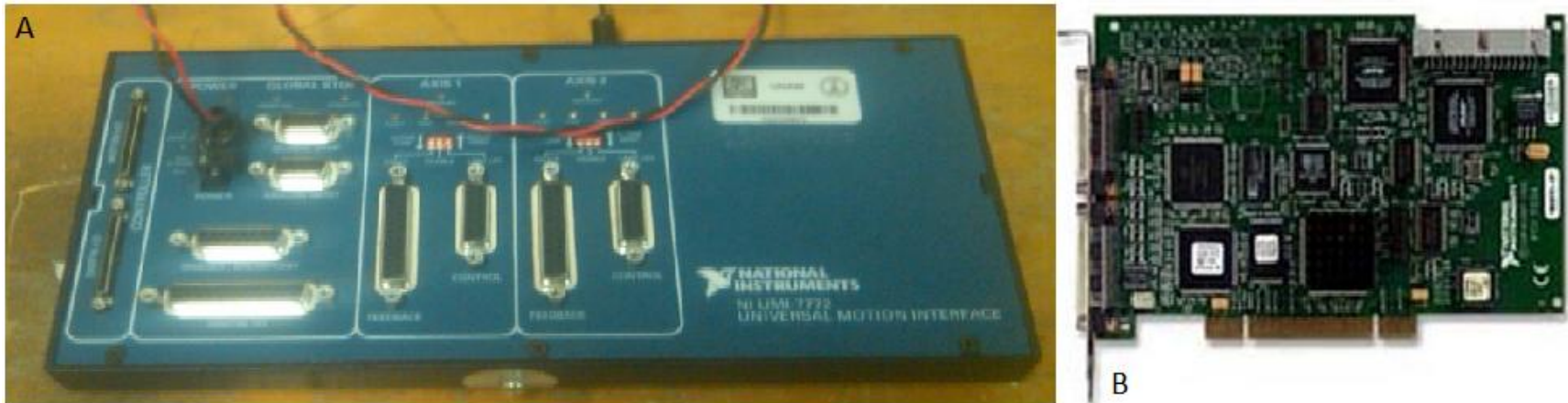
(A) Interfaz de Movimiento Universal (UMI-7772). (B) Tarjeta de control de movimiento (PXI-7342)
