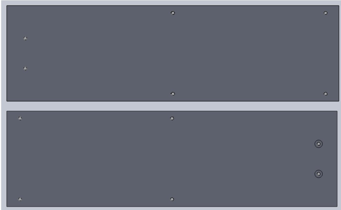
Fig. 3.38 Modelado virtual de la placa donde se montara el LPS y la placa para la base del fuelle
