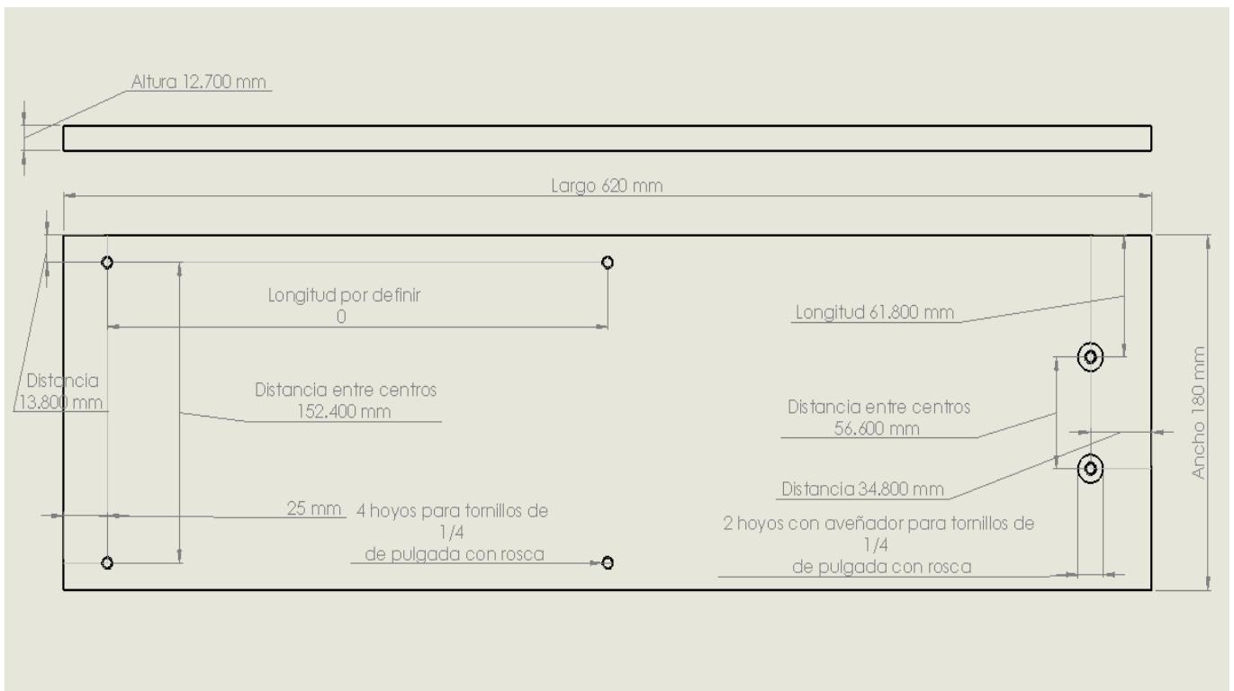
Fig. 3.39 Croquis de la placa donde se montara el LPS y la placa para la base del fuelle
