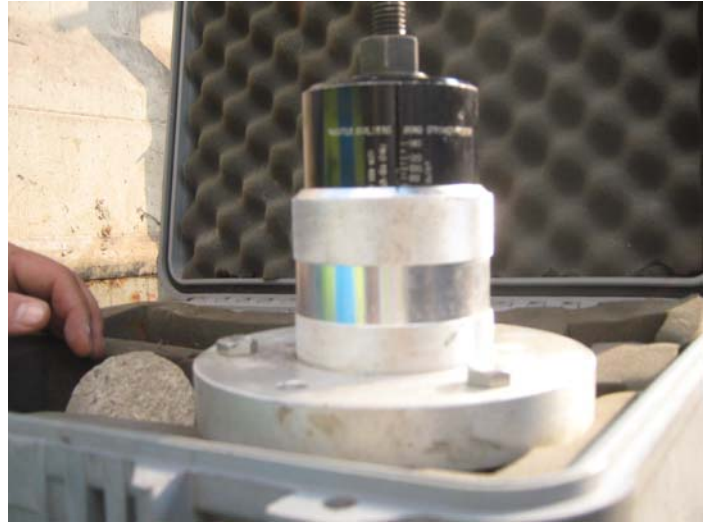
Figura 52. Herramienta de perforación y toma de muestras
