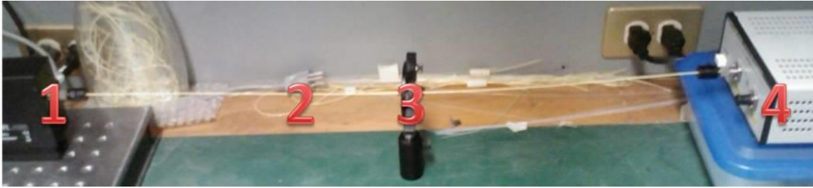
Figura 4.3-5.- Conexión de la fuente óptica de 1550 nm (4), la fibra óptica SMF 28 (2), el imán (3) y el sensor de la tercera ventana del infrarrojo del polarímetro (1)
