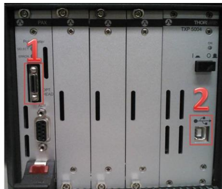
Figura 7.1-2.- Parte frontal del polarímetro, entrada del sensor (1) y entrada USB periférico (2)
