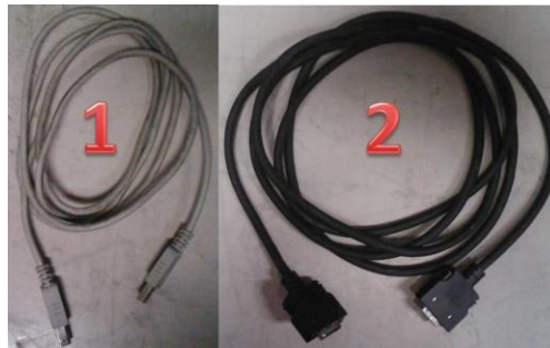
Figura 7.1-1.-Cables de conexión del polarímetro. Cable USB (1) y cable del sensor (2)+
