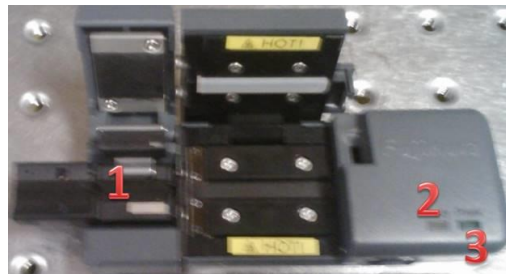
Figura 7.2-2.-Dispositivo térmico que desnuda la fibra óptica. Adaptador de corte (1), botón que indica cuando la fibra óptica está lista (2) y botón indicador de encendido (3)
