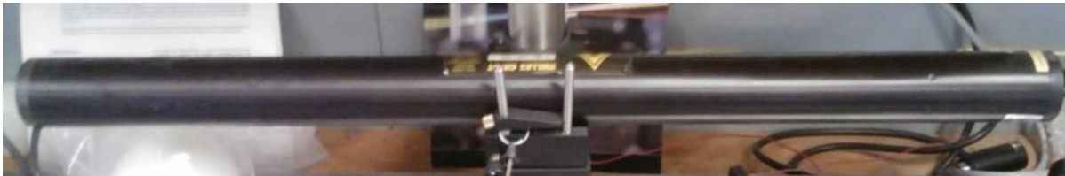
Figura 4.2-2.-Láser de luz roja a 633nm polarizado linealmente a 45^\circ
