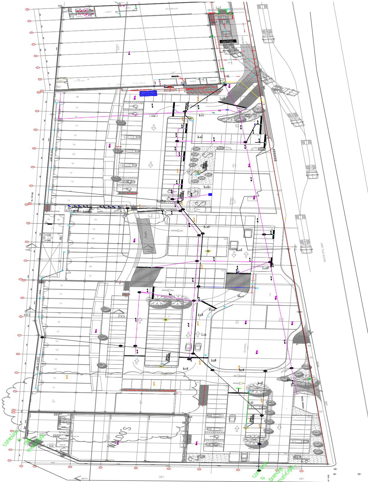
Plano de instalación sanitaria en locales con tubería de PVC. y red exterior con PAD.
