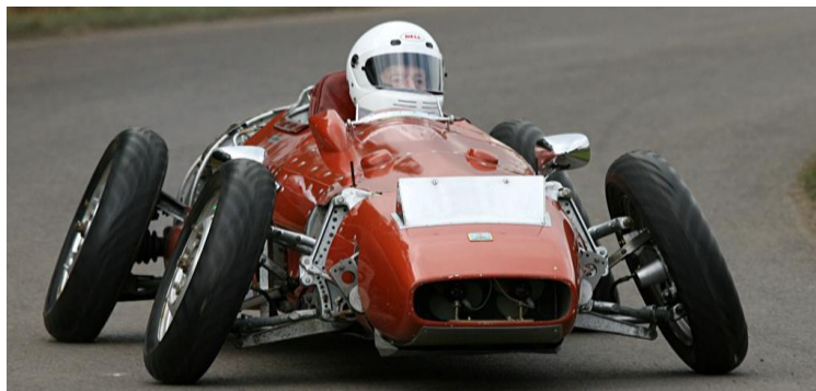
Figura 2.1-En esta figura se aprecia el vehículo Camber car Mx1 de Milliken. Tenía un camber de 22
