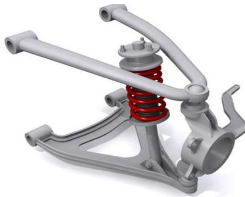
Figura 6.3.-La figura muestra la configuración de una suspensión de doble horquilla
