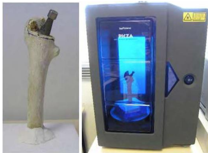
Imagen 3.1. Ensamble implante-fémur y escaneado laser 3D. (García, 2012)
