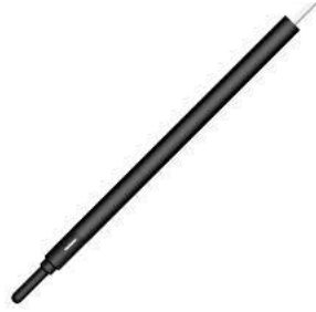
Figura 1..2 Cámara de Ionización Exradin A12 del IFUNAM
