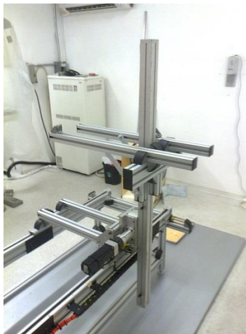
Figura 3.21 Mesa de experimentos de dosimetría de bajas energías.
