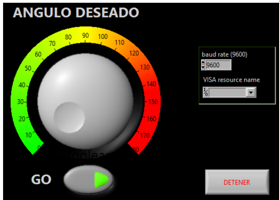
Figura 3.4: Interfaz gráfica para controlar en tiempo real un servomotor.
