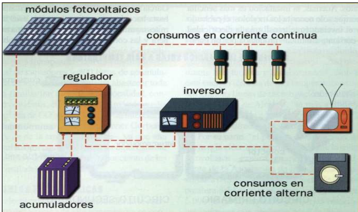
ESQUEMA DE INSTALACIÓN SOLAR FOTOVOLTAICA
