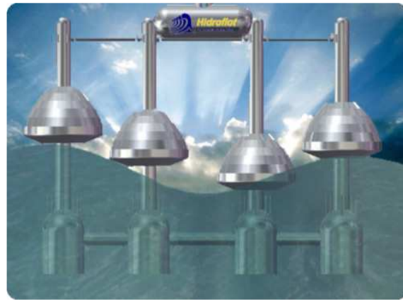
FLOTADORES GENERADORES DE ENERGÍA ELÉCTRICA DE MOVIMIENTO CON EL OLEAJE [Fuente: Prospectiva del Sector Eléctrico SENER 2005-2014, SENER 2005].
