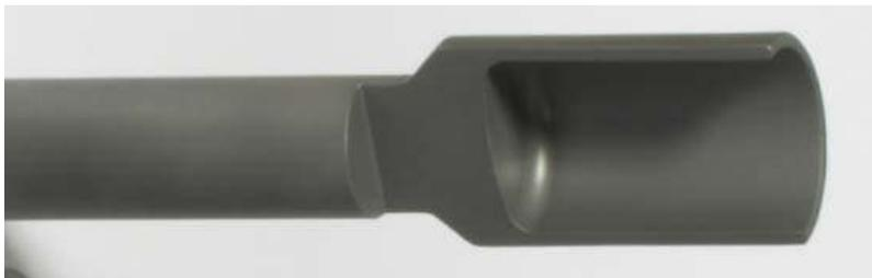
Figura 3.5: Eje de cromo hueco, manufacturado por medio del forjado en frío.
