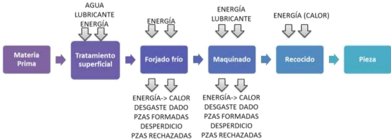
Figura 2.6: Producción de una pieza forjada, visto desde el sistema de contabilidad orientado al proceso.
