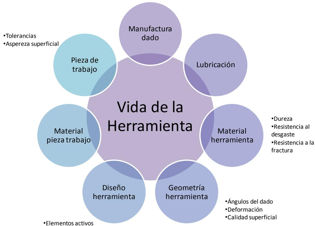
Figura 3.1: Diferentes aspectos de la herramienta, pieza de trabajo y proceso de formado que determinan la vida de la herramienta al afectar el comportamiento del desgaste y la fractura de la herramienta.
