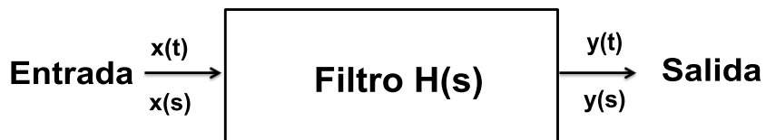
Figura 4.1. Representación simbólica de un filtro.
