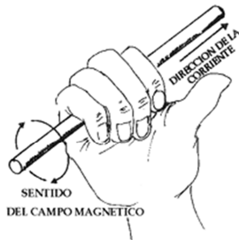
Determinación de la dirección del campo magnético por medio de la regla de la mano derecha.
