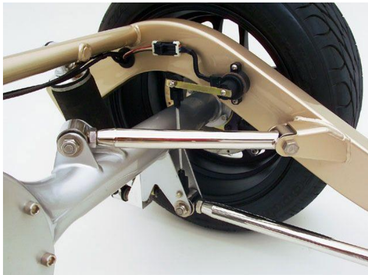
Figura 1.2 Suspensión tipo 4-Link [3]
