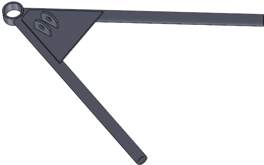
Figura 4. 24. Modelo de brazo de control frontal superior a analizar.
