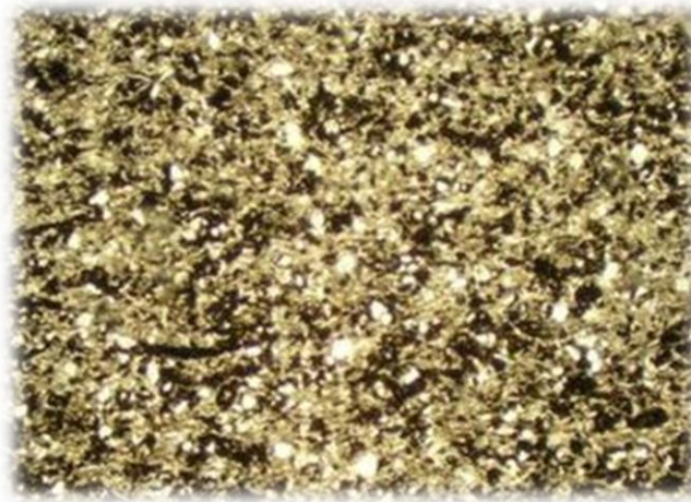
Figura 3.4. Muestra de lutita bajo el microscopio 10X.
