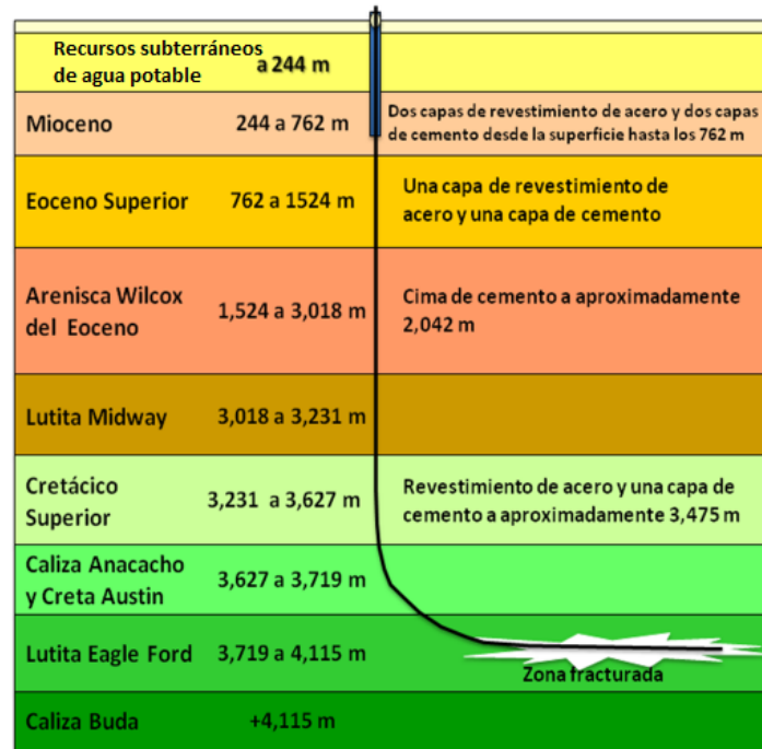
Figura 4.8. Esquemización de la perforación horizontal en una formación de lutitas del Play Eagle Ford.
