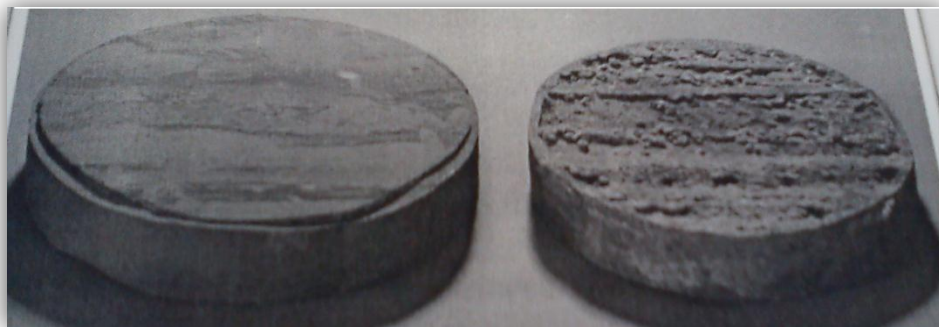
Figura 4.15. Muestra de calcita, antes y después del tratamiento de fracturamiento ácido.
