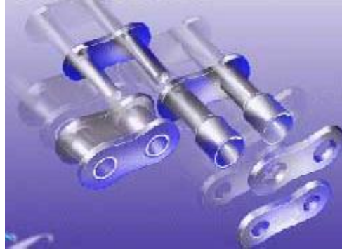
Fig. 4 Componentes de la cadena de rodillos: placa lateral, rodillo y pasador.
