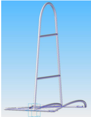
Fig. 18 y 19 Reproducción gráfica en CAD de la estructura trasera del vehículo y la propuesta del tren motriz
