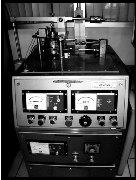
Figura 2.7 Equipo de desgaste y fricción 'Cignus'.
