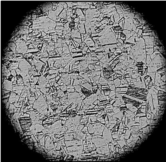
Figura 3.8. Metalografía de acero AISI 316.
