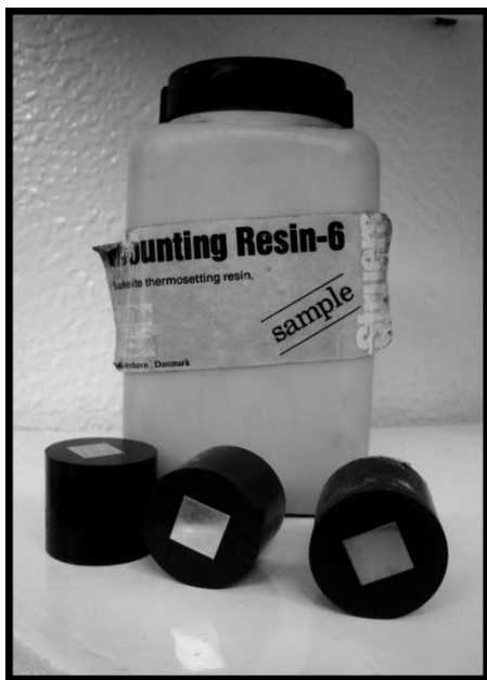
Figura 2.2. Muestras montadas y resina utilizada.
