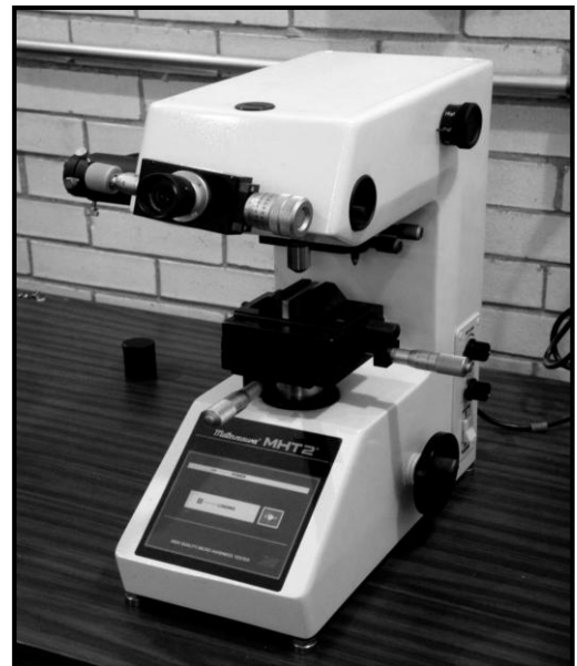
Figura 2.5. Equipo de microdureza Vickers Matsuzawa MHT2.
