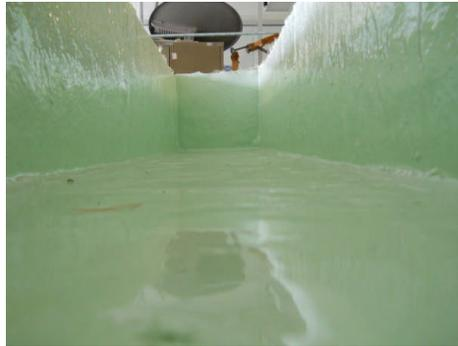
*Fig. 2.1 Vista interior de la superficie del cajón de madera con el recubrimiento epóxico impermeable.<sup>44</sup>*
