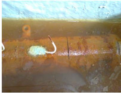
*Fotografía 1.1 Metal sumergido en agua salada gravemente corroído.*
