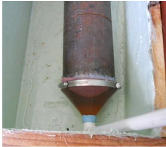
*Fig. 2.6 Vista de un extremo del tubo que muestra la colocación final de los embudos.*
