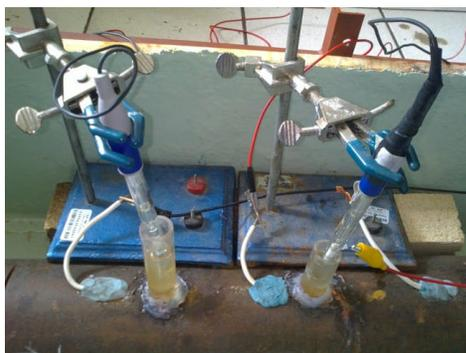
*Fig. 2.11 Disposición de los elementos para realizar la prueba de resistencia a la polarización.*
