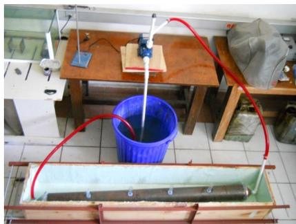
Fig. 2.9 Vista final del sistema de bombeo de flujo constante.
