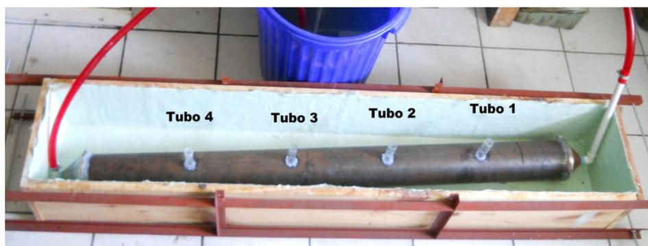
Fig. 3.3 Posición de los 4 tubos de acrílico.
