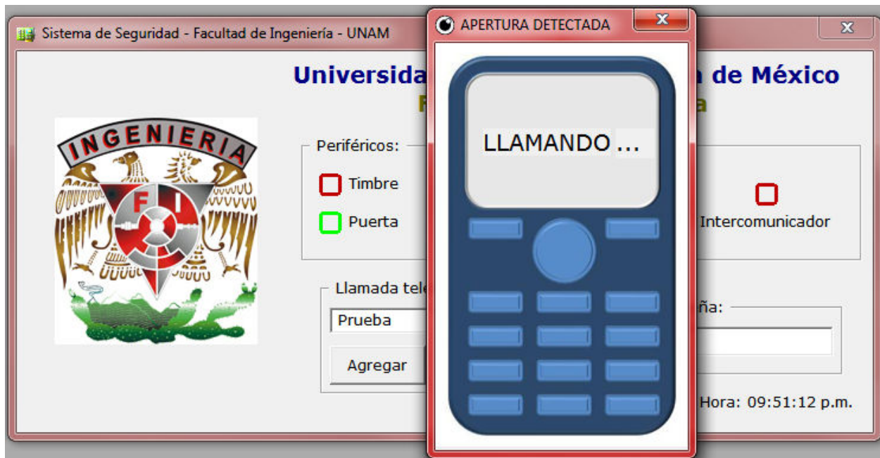
Figura 6.11. El sistema envía el comando al teléfono celular para establecer la llamada telefónica al usuario.
