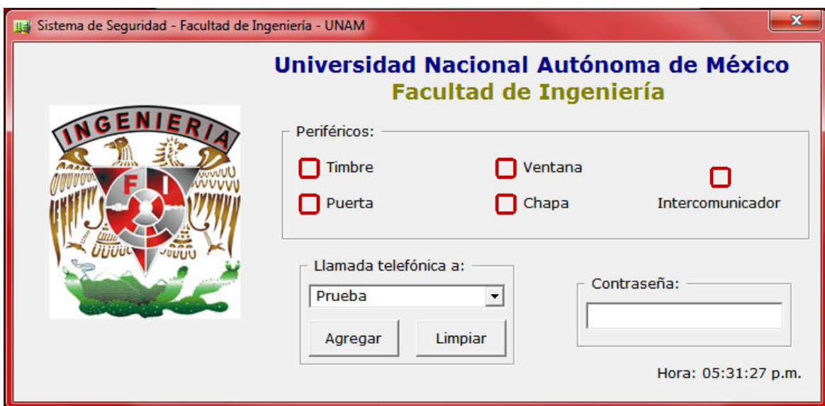
Figura 6.10. Ventana principal de la aplicación instalada en la PC para el sistema de seguridad.
